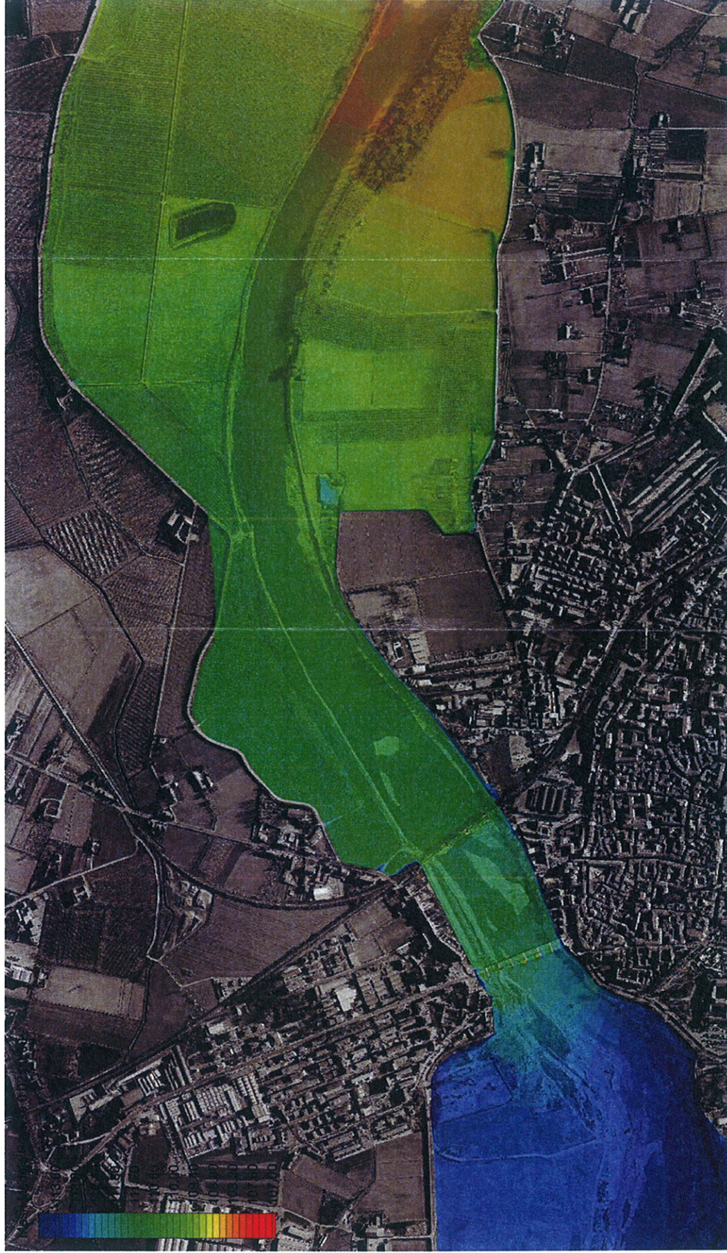
Livelli idrici d'assetto migliorativo, simulazione dell'evento dell'Ottobre 2000
