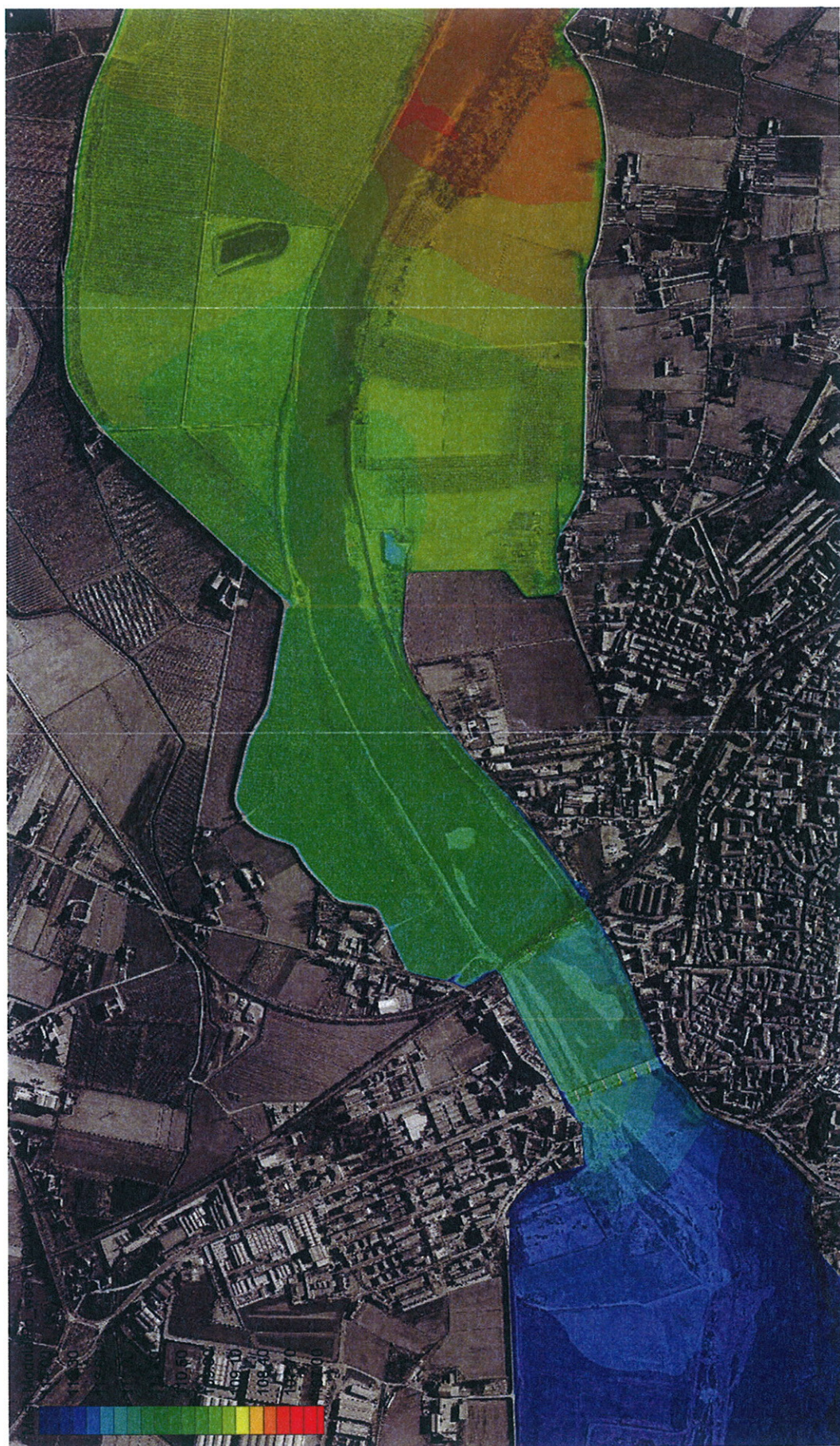
Livelli idrici di stato di fatto, simulazione dell'evento dell'Ottobre 2000
