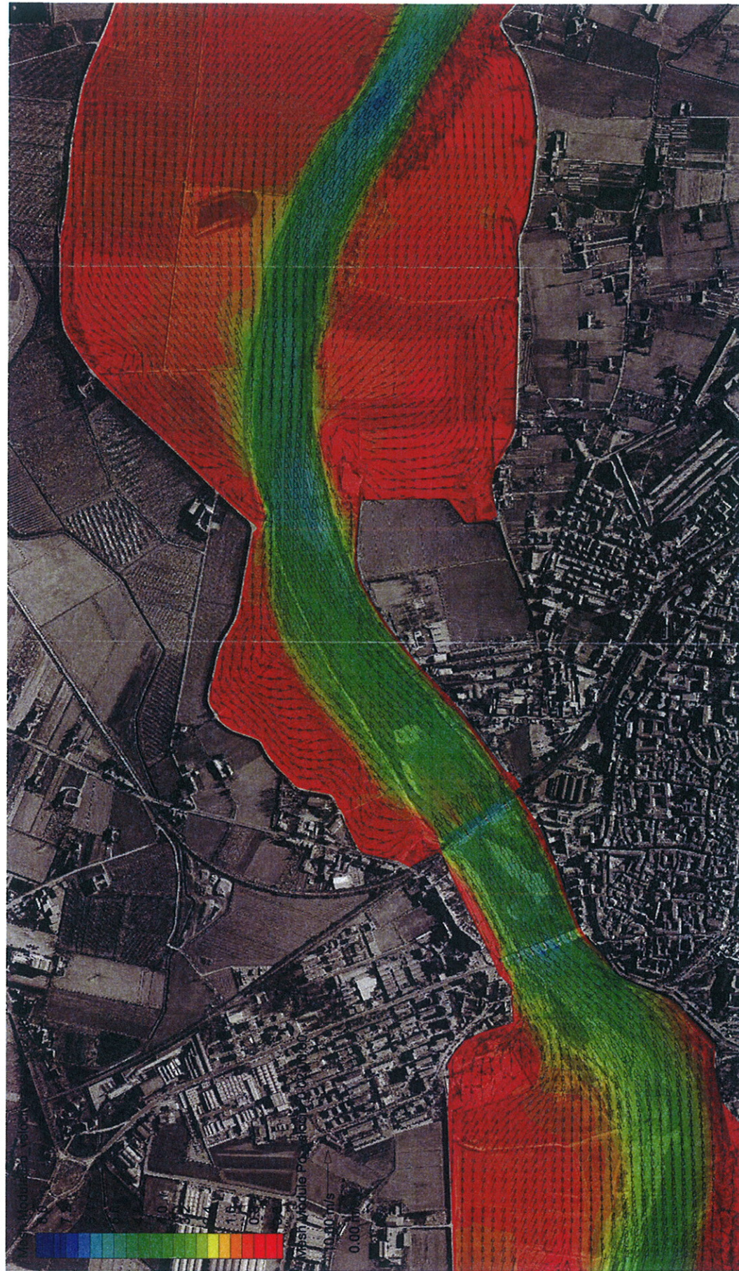
Modulo e vettori della velocità di stato di fatto, simulazione dell'evento dell'Ottobre 2000
